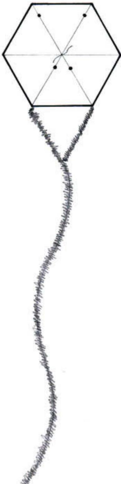
Der Durchmesser des Drachen beträgt 120 cm, wir benötigen also 3 Kohlefaserstäbe mit einer Länge von 120 cm (nach Fertigstellung des Segels anpassen). Für das Segel nehmen wir weißes Spinnakernylon (110 cm bei einer Breite von 150 cm reichen aus). Die Applikation besteht aus einer 10 cm breiten schwarzen Linie, einer 5 cm breiten roten Linie, zwei schwarzen Punkten mit einem Durchmesser von 11 cm bzw. 7 cm und einem roten Punkt;  $\varnothing$  9cm.
