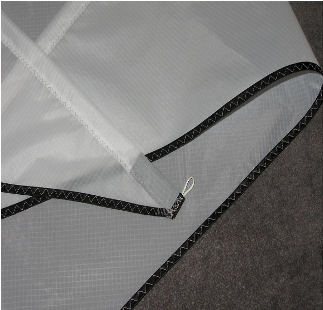
4. Am Kiel eine Hilfslinie (1 cm vom Rand) anzeichnen, Verstärkung auf den Kiel aufnähen, Kiel auf 3 Seiten säumen, danach Stabtunnel auf den Kiel aufnähen, am unteren Ende den Stabtunnel offen lassen. Kleine Schlaufe = unterer Waagepunkt auf die Kielverstärkung aufnähen.
