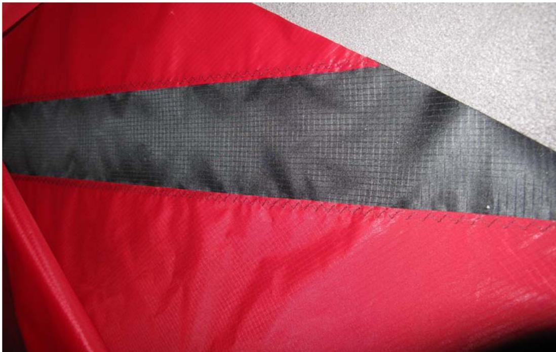
2. Die 4 Verstärkungen auf das Untersegel aufnähen, danach die 2 schrägen Seiten und die kurzen vertikalen Seiten im Bereich der Stabtaschendamronverstärkung säumen, siehe Bild
