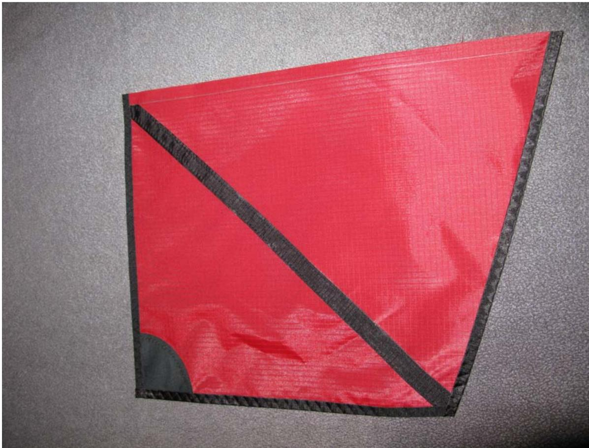
5. Lage des Kiels am unteren Segel per Hilfslinie anzeichnen, Kiel darüber legen die 2 Hilfslinien genau übereinander legen und mit einem geraden Stich annähen, danach den Überstand einmal nach innen klappen und per ZickZack annähen. Mittellange Spinnakerschlaufe auf die untere Verstärkung aufnähen, danach Stabdurchführung aufnähen, damit ist das Untersegel fertig ...
