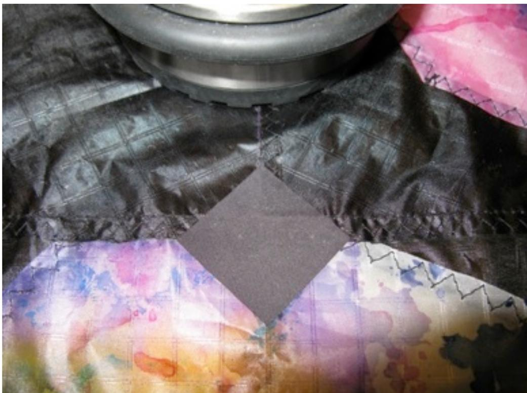
**Dann an jeder Ecke ein kleines Loch durchbrennen, dort werden die Pfeilnocken/Splitkappen eingehängt, auch die Spannleine kann so direkt in die Splitkappen eingehängt werden, ohne jede Näharbeit, Lasche o.ä. Diese Technik eignet sich mit der zuvor aufgenähten Verstärkungsleine an den Ecken für Drachen bis etwa 180 cm Höhe, darüber werden die Kräfte an den Eckpunkten zu hoch.**
