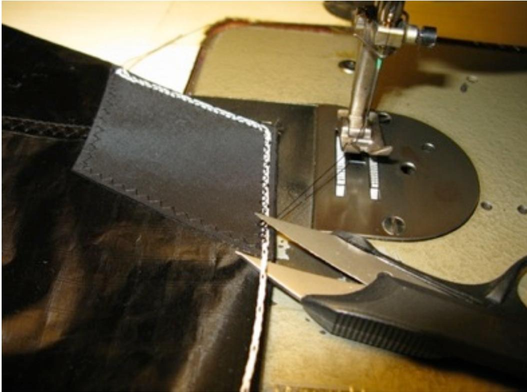
**Anschließend das Segel säumen, so wird die Leine abgedeckt**
